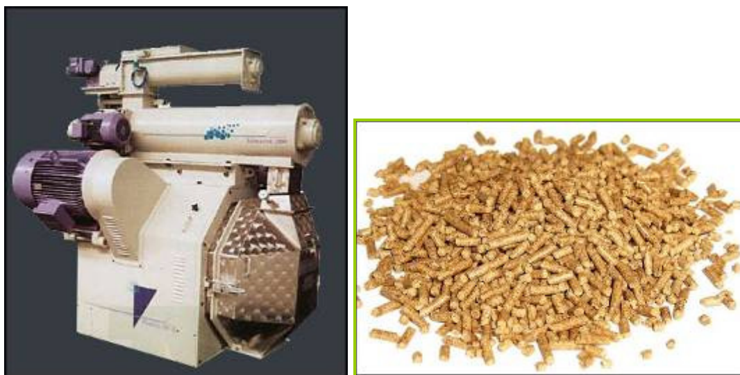
Slika 20: Stroj za izdelavo peletov in peleti
